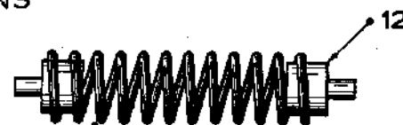
RESSORT FLECHISSANT DE 1mm POUR 2 KG vendu sous le n° 2422-T ce ressort est peint en rouge
