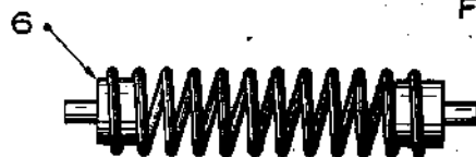
RESSORT FLECHISSANT DE 1mm POUR 1 KG vendu sous le n° 2421-T ce ressort est peint en jaune
